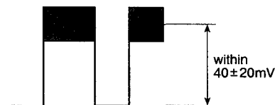
Рис. 7. Осциллограмма контрольного сигнала при регулировке параметра SECAM B-L
