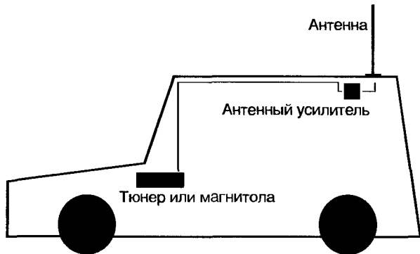
Рис. 1. Места установки антенны, усилителя и магнитолы
